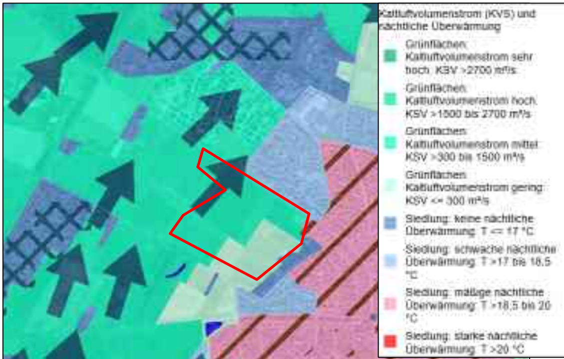
Abbildung 21: Das Plangebiet (rote Umrandung) mit nächtlicher Überwärmung und Kaltluftvolumenstrom (LANUV NRW 2020)
